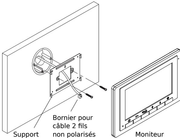
Fixer solidement la plaque arrière du moniteur. Les trous de fixation de la plaque arrière (entraxe : 65mm) sont compatibles avec les boîtes d'encastrement électriques standards. Raccorder le Bus 2Easy sur les borniers L1 et L2 par 2 fils non polarisés.
