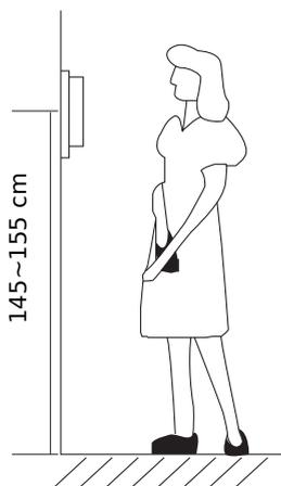
La hauteur d'installation suggérée pour le moniteur, quand cela est possible, est d'environ 145 cm à 155 cm depuis le sol pour un confort normal en position debout.
