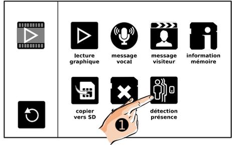
La détection de présence en option doit être câblée sur les platines de rue, paramétrée et activée pour chaque platine concernée
