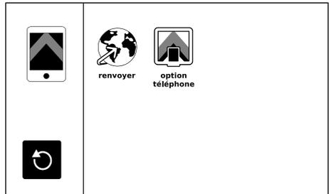
Ces fonctions ne sont plus utilisées dans les installations neuves, elles sont réservées pour les moniteurs en remplacement dans une ancienne installation équipée de module séparé GSM+SIM avec abonnement et en fonctionnement. Il faudra alors se reporter à la notice qui était livrée avec le module séparé GSM+SIM pour programmer le moniteur.
