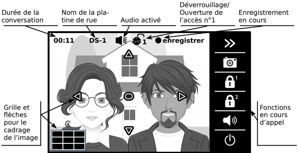
**Note :** La grille et les flèches pour le cadrage de l'image se s'affichent que si l'appel est passé depuis une platine avec une caméra avec un **angle de prise de vue de 170°**.
