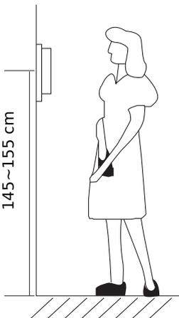
La hauteur d'installation suggérée pour la platine, quand cela est possible, est d'environ 145 cm à 155 cm depuis le sol pour un confort normal en position debout.
