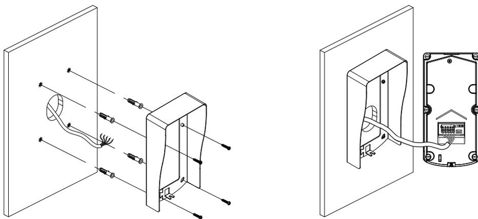
Fixez d'abord la visière anti-pluie puis connectez le câble au bornier arrière.
