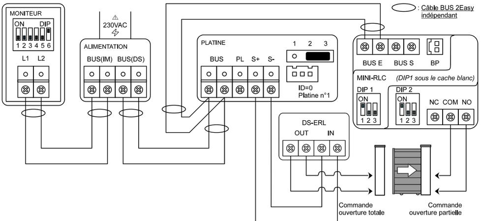
**9. Installation avec 4 moniteurs "en série" dans 1 logement pour 1 platine**
