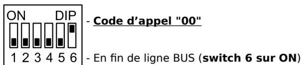
Réglage des switches du Mini-RLC (voir réglages : "Câblage d'une deuxième commande") :
