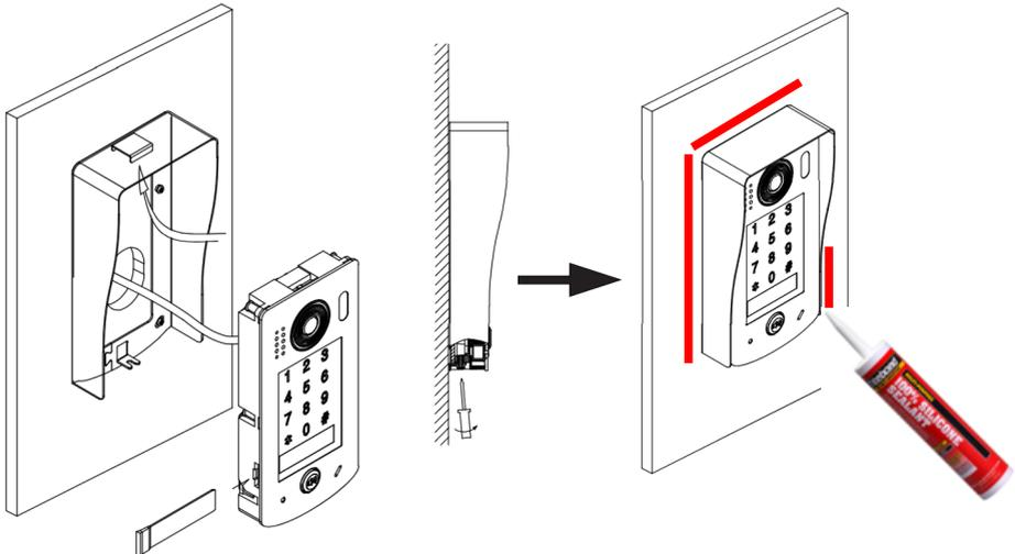
Inscrivez le nom du résident sur la plaquette amovible du porte-nom, glissez la sous la protection, et insérez la platine de rue sous la visière anti-pluie. Fixer la platine avec la vis accessible par en dessous afin d'assembler la platine de rue avec la visière anti-pluie et y ajouter un joint silicone sur les 3 côtés (pas dessous).
