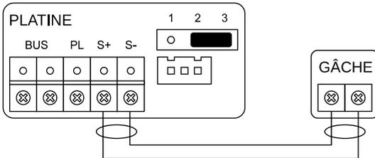
**Attention** : au repos, 0V sont délivrés par la platine sur les bornes S+/S-.
