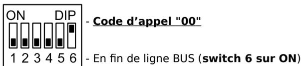
Réglage des switches du Mini-RLC-C (voir réglages : Câblage d'une deuxième commande)
