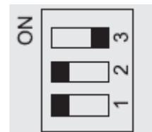
3° REMETTRE LE DISJONCTEUR ET DANS LES 5S MAXI BOUGER LE SWITCH 1 POUR 4 FOIS
